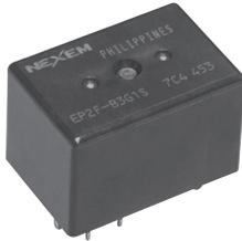
EP2 系列为印刷电路板安装类型，最适合汽车中各种要求高质量和高性能的电机控制。
